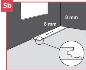
**5** Com o encaixe Unidlic® do pavimento SPC vinílico NewVinyl, pode escolher onde começar no pavimento. Pense sobre qual será a melhor forma de instalar o pavimento. Iremos demonstrar a instalação do pavimento NewVinyl para destros, da esquerda para a direita (do ponto de vista dianteiro). Graças ao sistema de encaixe Unidlic®, pode trabalhar em qualquer direção.
