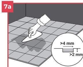
**7** As juntas de cimento entre ladrilhos e outras de mais de 2 mm de profundidade e 4 mm de largura devem ser niveladas (7a). No caso do pavimento de encaixe SPC vinílico NewVinyl: qualquer desnivelamento de mais de 1 mm superior a um comprimento de 20 cm deve ser nivelado (7b). O mesmo aplica-se a um desnivelamento superior a 2 mm ao longo de um comprimento de 2 m (7b).
