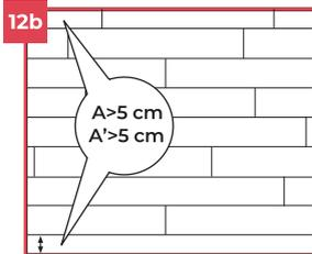
As juntas de controlo do suporte e juntas de dilatação da construção, devem ser transpostas para o pavimento SPC vinílico NewVinyl, instalando um terminal nestes pontos.
