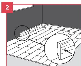
**2** Inspeção a superfície final do pavimento instalado. Instale quaisquer peças de transição que sejam necessárias como terminais e rodapés NewVinyl. Mas nunca aperte o rodapé contra o pavimento, apenas faça pousar o rodapé, fixando-o à parede. Este método permite que o pavimento se expanda e/ou contraia sob o rodapé.
