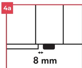
**4** Ao serrar as peças, certifique-se de que a junta de dilatação por baixo da porta é de 8mm (4a). Se não conseguir levantar o painel (p. ex. por baixo de radiadores), use o bloco de união ou a barra de fecho para unir as peças (4b).
